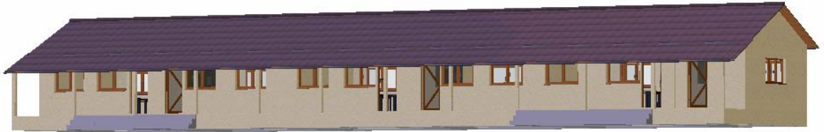
Toiture en tôle de zinc
